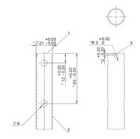
1. 枪口 2. 壁厚不得小于1 mm 3. 枪管安装后,此U型槽方向向上
