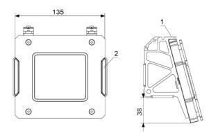
1. 装甲支撑架顶部M4固定孔 2. 装甲指示灯
