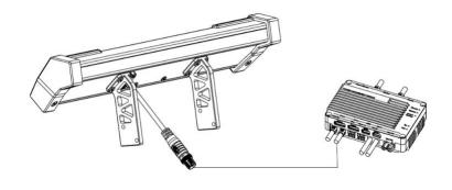
△ 安装步兵机器人的灯条模块时,主灯条部分要高于装甲模块上沿。
