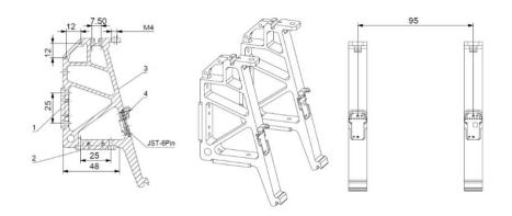
1. 后部安装面 2. 底部安装面 3. 装甲模块安装面 4. 电气接触点
