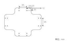
2. 使用 M4 螺丝将支撑架 A 固定至底盘上。
