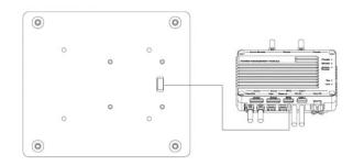
3. 使用 M3 螺丝固定裁判系统场地交互模块至底盘,安装时切勿压到连接线,并注意保持交互模块与地面有适当的距离。
