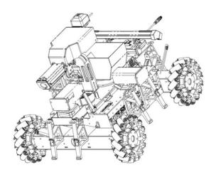
3. 安装装甲模块至支撑架,并使用 M4 螺丝固定。装甲支撑架顶部螺纹孔不和支撑架顶面垂直,在正确安装支撑架的情况下顶面螺纹孔与水平面垂直。机器人的侧面装甲模块受攻击面 145°内不得被遮挡。
