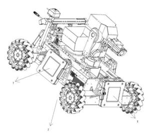
机器人本身的运动学方程须建立以笛卡尔坐标系为参考的机体坐标系下。如果参赛机器人使用非笛卡尔坐标系建立运动学模型,则机体坐标系定义为:机器人最大口径的发射机构初始状态下射出弹丸的方向向量投影到XY平面作为X轴,根据X轴和指向地心的Z轴按照右手定则生成Y轴,原点为机器人的质量中心。
