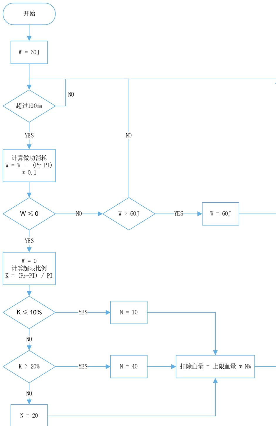
图 3-3 底盘功率检测及扣血逻辑图
