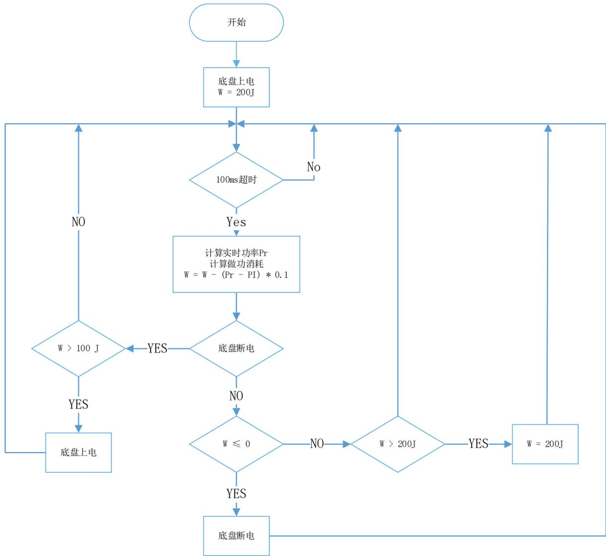
图 3-4 底盘功率检测及底盘断电逻辑图
