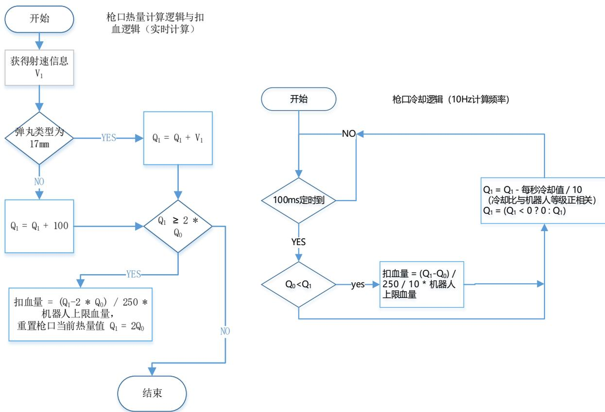
图 3-2 枪口热量超限的扣血逻辑图（左）和冷却逻辑图（右）
