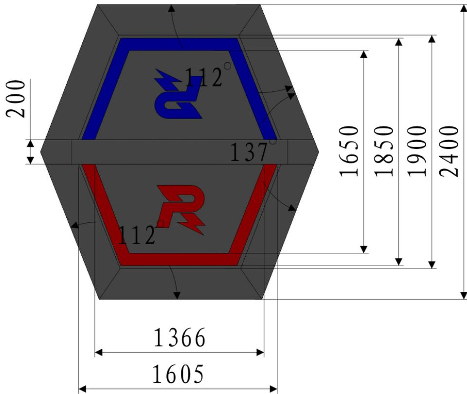
图 4-29 加成点尺寸示意图
