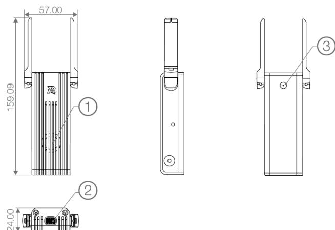
[1] 出风口 [2] 进风口 [3] 英制螺纹孔 1/4 20×6
