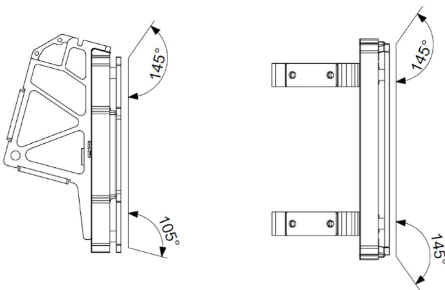
**S102** 工程机器人的所有装甲模块受攻击面下边缘  $105^\circ$  内不得被遮挡。所有的装甲模块下方的机器人外边缘与装甲模块下边缘的垂直距离小于  $100\text{mm}$ 。四块装甲模块中至少三块装甲模块满足上、左、右边缘  $145^\circ$  内不被遮挡，允许有至多一块装甲模块可以在受攻击面上、左、右边缘的  $145^\circ$  内发生有条件遮挡，遮挡条件为：在该装甲模块受攻击面所在的平面上，距离装甲模块的上边缘大于  $150\text{mm}$ ，或距离左、右边缘大于  $170\text{mm}$  可以发生遮挡，即下图阴影部分不可被遮挡。
