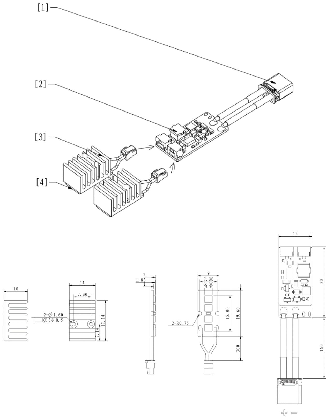
[1] XT30 端口 [2] LED 驱动器 [3] 散热片 [4] 紫外灯板
