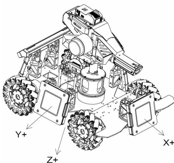
图 3-17 机器人坐标系示意图
