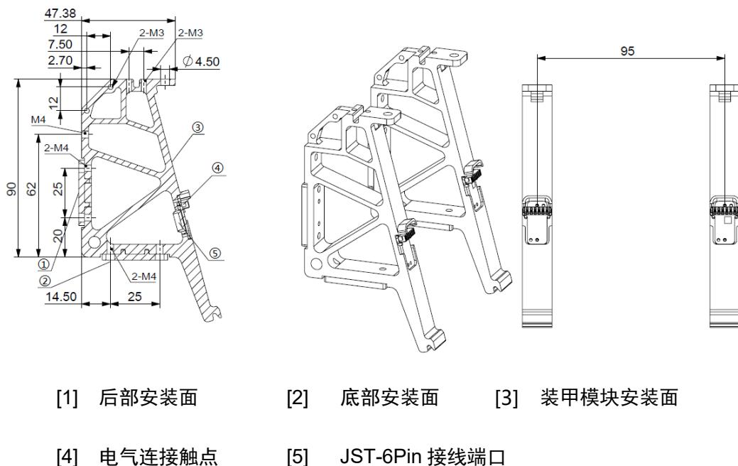
图 3-14 指定装甲支撑架示意图
