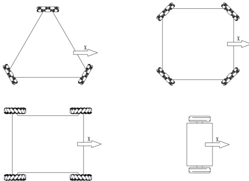
图 3-18 机器人不同底盘形态 X 轴示意图
