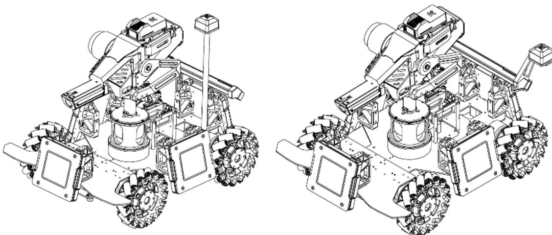
图 3-45 定位模块安装示意图
