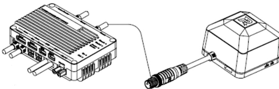
图 3-46 定位模块连线示意图
