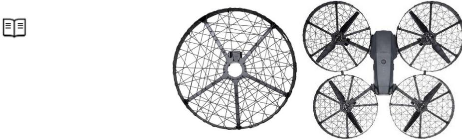
S56 全封闭桨叶保护罩受 2 m 距离外速度为 12 m/s 的 42 mm 弹丸射击后，保护罩任意部分不可产生接触桨叶的形变，影响桨叶的正常转动，且该 42 mm 弹丸不可穿过保护罩网孔，建议保护罩最大网孔面积不大于 9 cm<sup>2</sup>。
