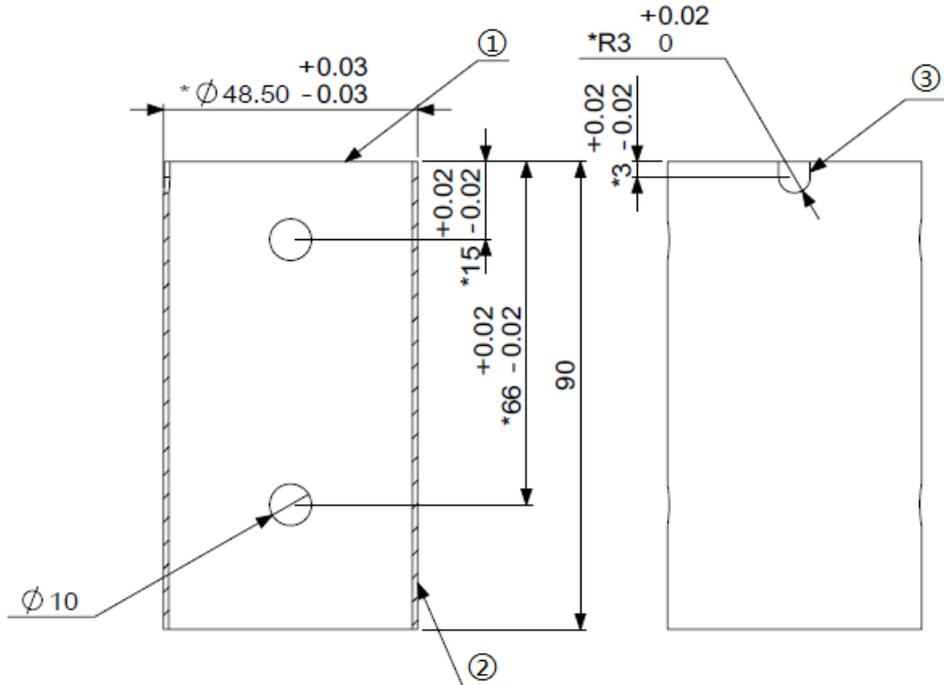
[1] 枪口 [2] \* 壁厚不得小于 1mm [3] 枪管安装后，此 U 型槽方向向上
