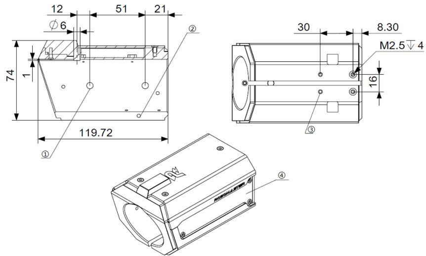
[1] 光电管 [2] 枪口夹紧螺钉孔
