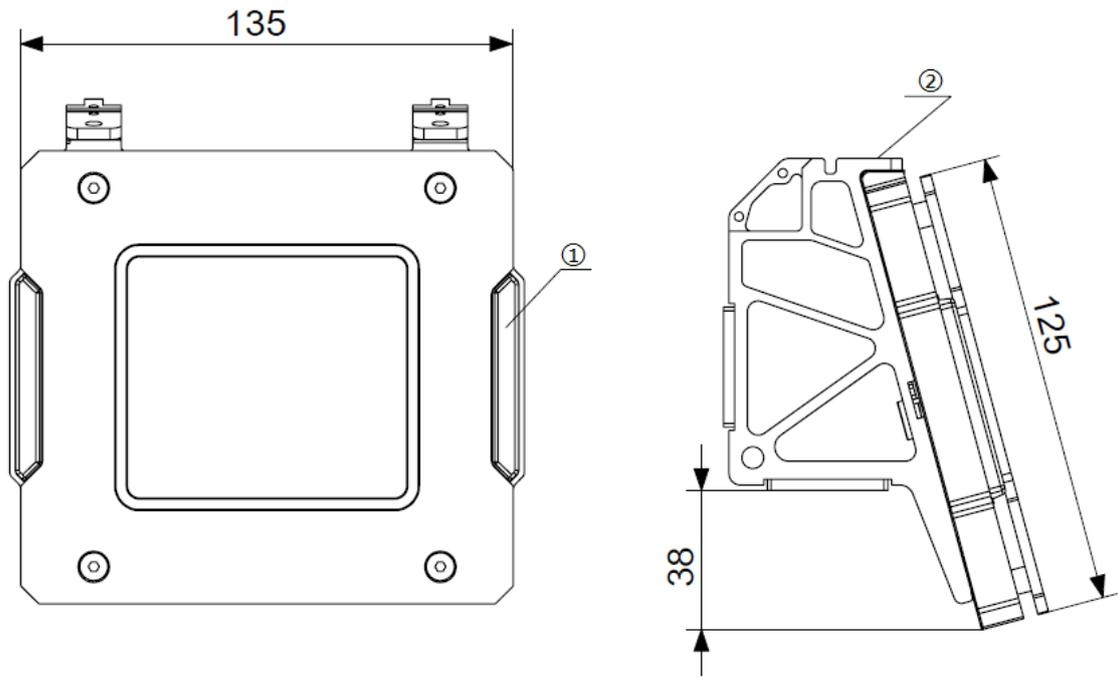
[1] 侧灯 [2] 顶部用 M4 螺钉固定
