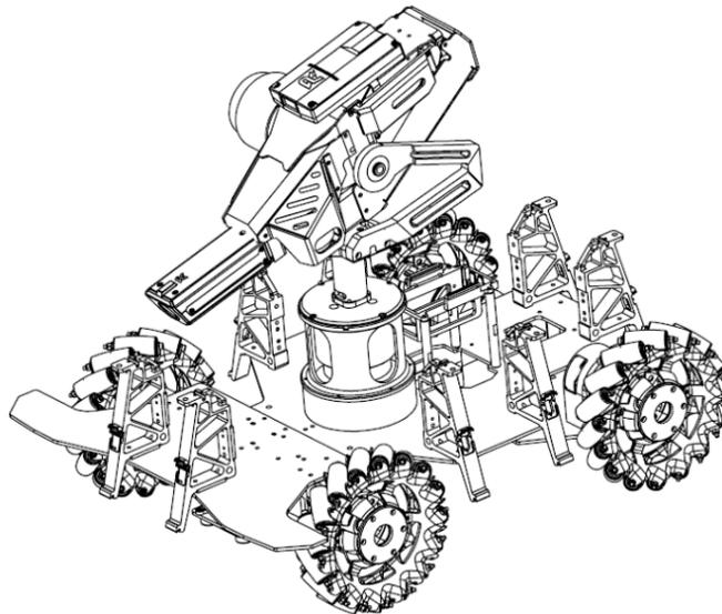
图 3-21 装甲支撑架安装示意图
