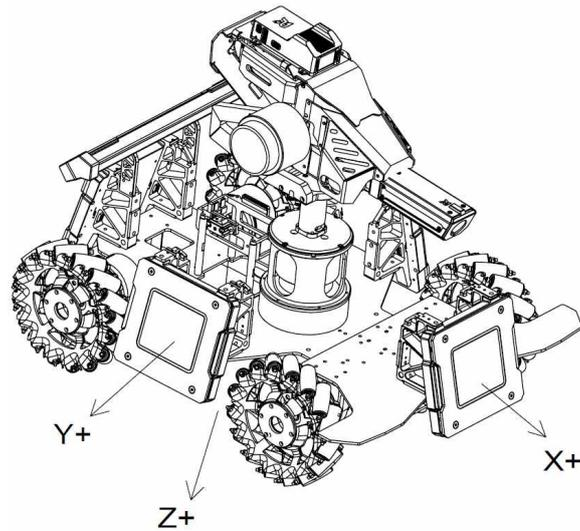
图 3-16 机器人坐标系示意图
