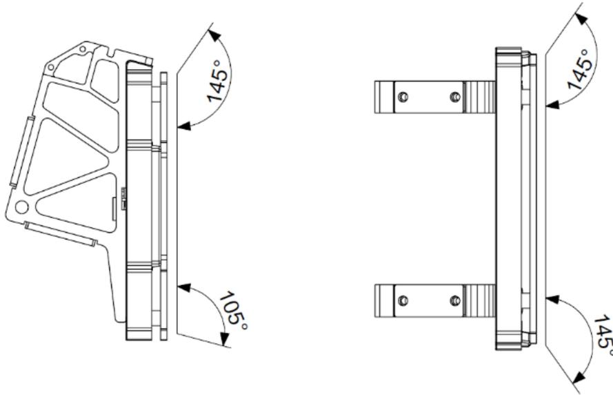
**S106** 工程机器人的所有装甲模块受攻击面下边缘 105°内不得被遮挡。所有的装甲模块下方的机器人外边缘与装甲模块下边缘的垂直距离小于 100mm。四块装甲模块中至少三块装甲模块满足上、左、右边缘 145°内不被遮挡，允许有至多一块装甲模块可以在受攻击面上、左、右边缘的 145°内发生有条件遮挡，遮挡条件为：在该装甲模块受攻击面所在的平面上，距离装甲模块的上边缘大于 150mm，或距离左、右边缘大于 170mm 可以发生遮挡，即下图阴影部分不可被遮挡。
