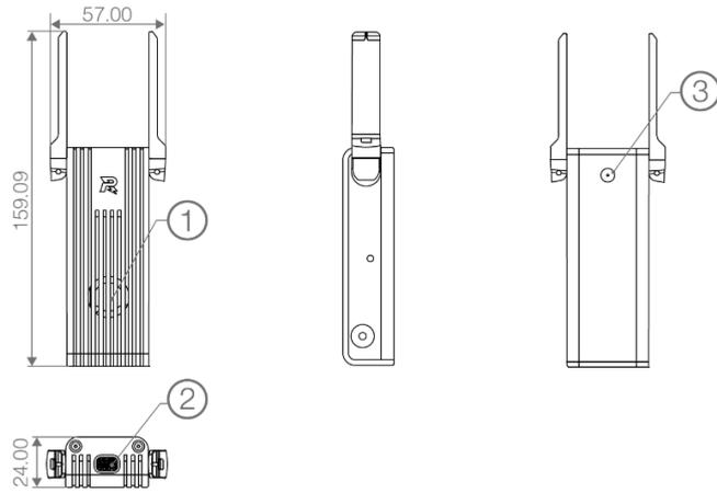
[1] 出风口 [2] 进风口 [3] 英制螺纹孔 1/4 20×6
