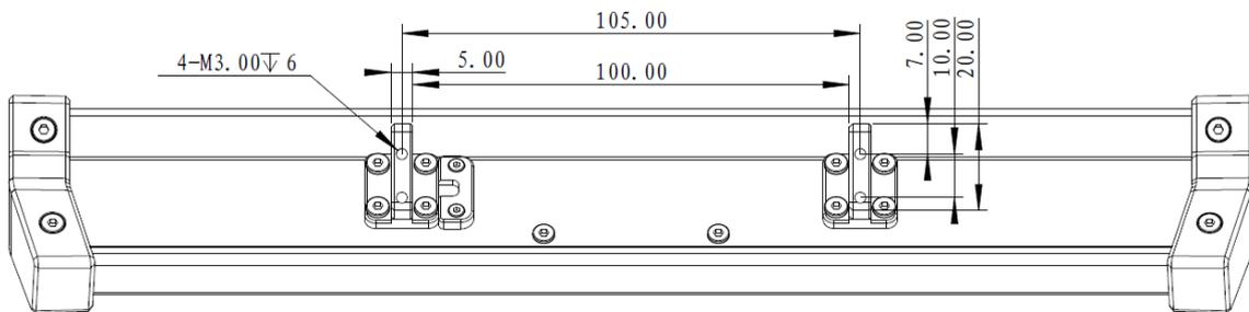
图 3-11 灯条模块底部示意图
