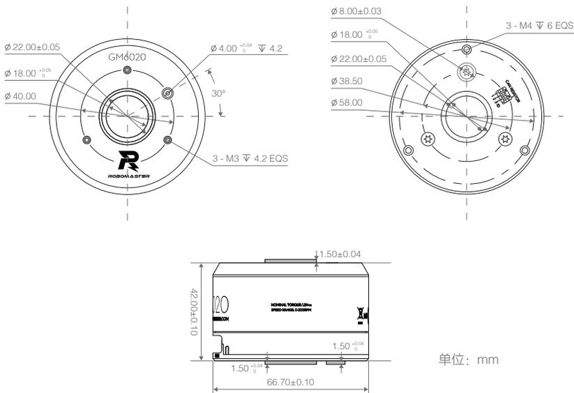
⚠ 电机转子端安装螺纹孔为 M3，深度 4mm；电机定子端安装螺纹孔为 M4，深度 6mm，请选择合适的螺丝进行安装。
