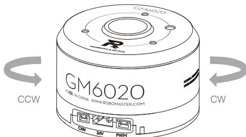
从电机输出轴端观察，规定 CCW（逆时针）转动为正向，CW（顺时针）转动为反向。
