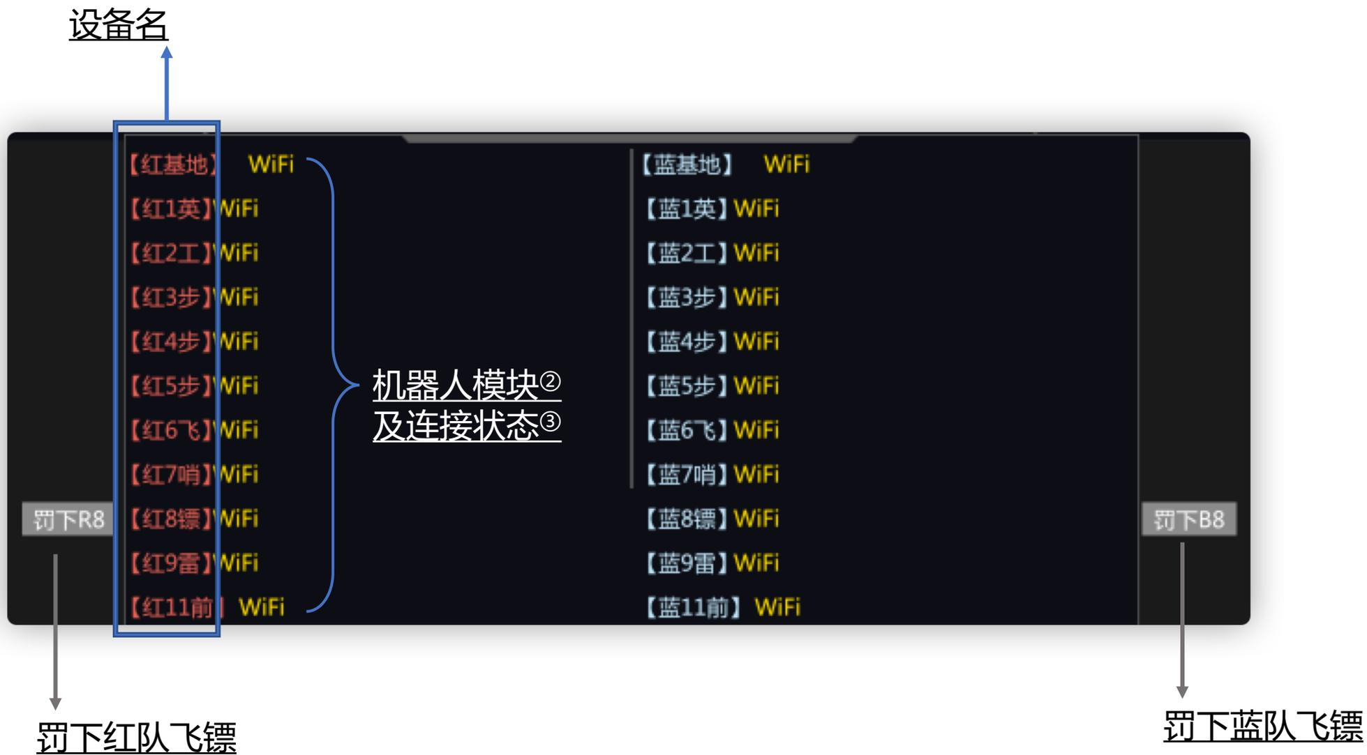
机器人模块<sup>②</sup> : Client (客户端)、WIFI (主控)、Armor (装甲)、Speed Mon (测速)、Light Ind (灯条)、RFID (场地交互)、UWB (定位)、VTM (图传)、CAP (电容管理)
